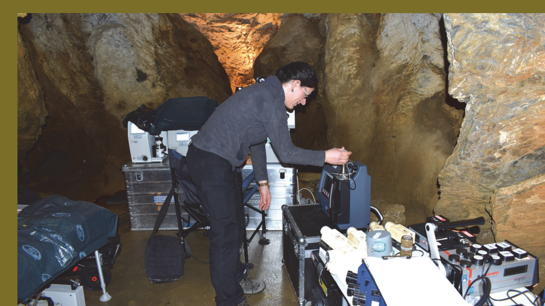
Hromady beden jako na rockovém koncertě si vyzádaly výzkum vztahu aerosolových částic a dceřiných produktů radonu, které se v jeskyních přirozeně vyskytují. The piles of crates like at a rock concert were required for research into the relationship between aerosol particles and radon daughter products that occur naturally in caves.
