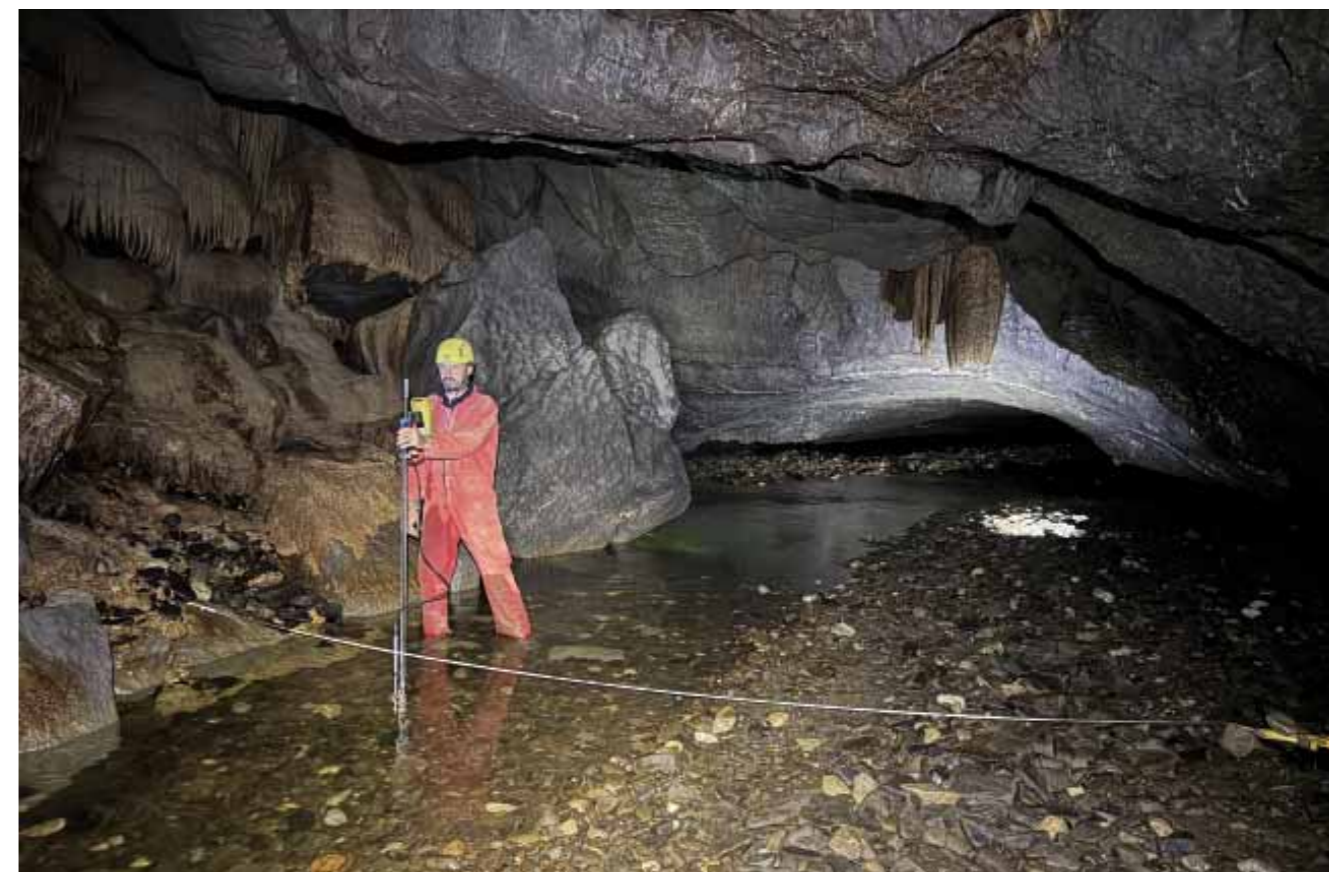
Obr. 1: Měření průtoku v měrném profilu pod Dómem objevitelů ve Staré Amateřské j.
