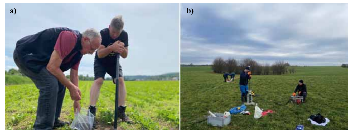
Obr.1. a) odběr vzorku z kopané půdní sondy; b) vrtání mělkého vrtu pro vzorkování půdního vzduchu na Harbešské plošině. V pozadí příprava RERT profilu.
