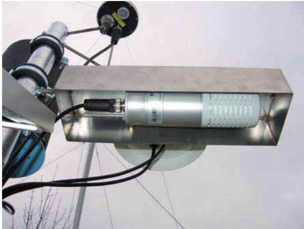
Obr. 24 Snímač koncentrací CO 2 od firmy Vaisala, chráněný před povětrnostními vlivy stříškou z nerezového plechu.
