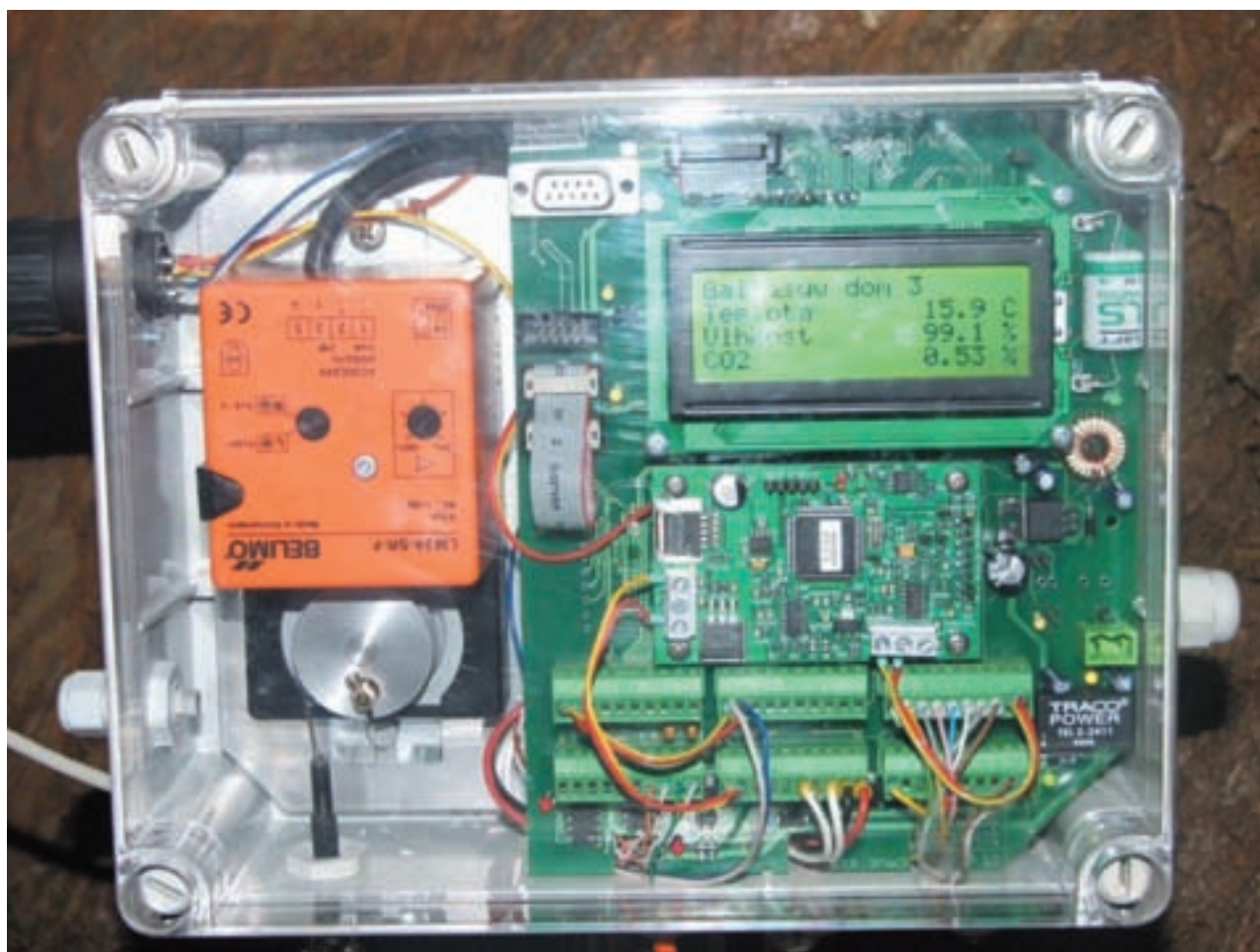
Měřicí jednotka sledující jednotlivé parametry mikroklimatu ve Zbrašovských aragonitových jeskyních.
